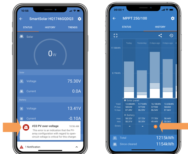
VictronConnect-app fout #33 indicatie op het statusscherm en geschiedenis scherm
